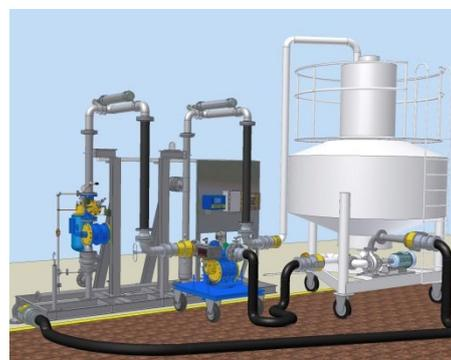
Fig.3: Master Meter con misura campione
