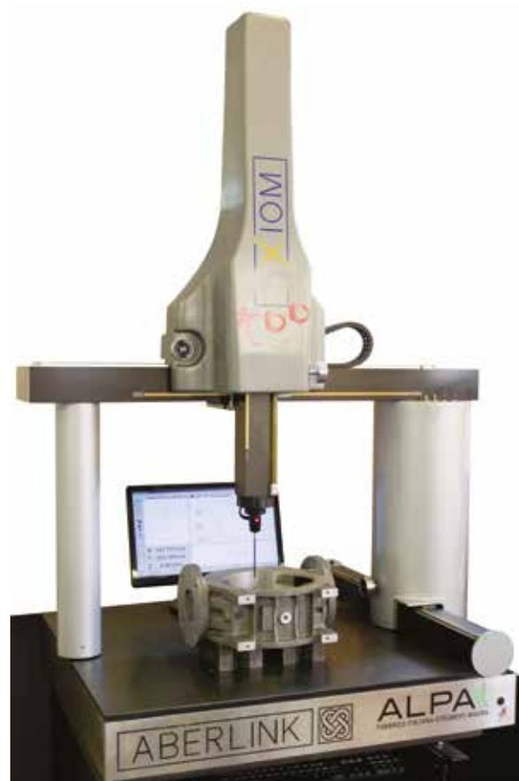
Controllo tridimensionale di componenti con macchina di misura 3D
